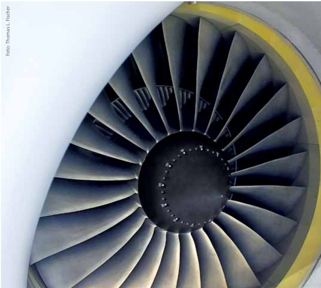
Detailansicht eines CF34-10E5 Triebwerkes einer typgleichen Embraer 195 der Air Europa
